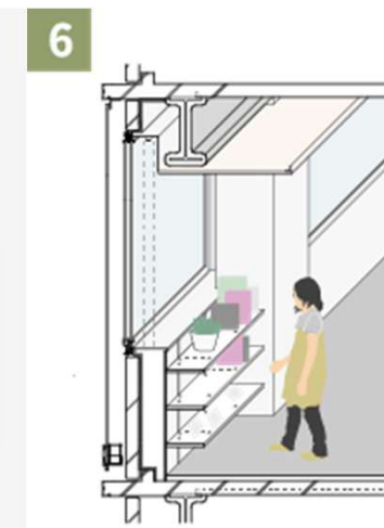
棚柱にレール棚を設置 して収納スペースに
